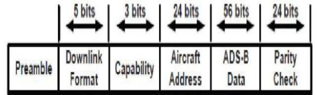
Fig. 4. ADS-B message format
